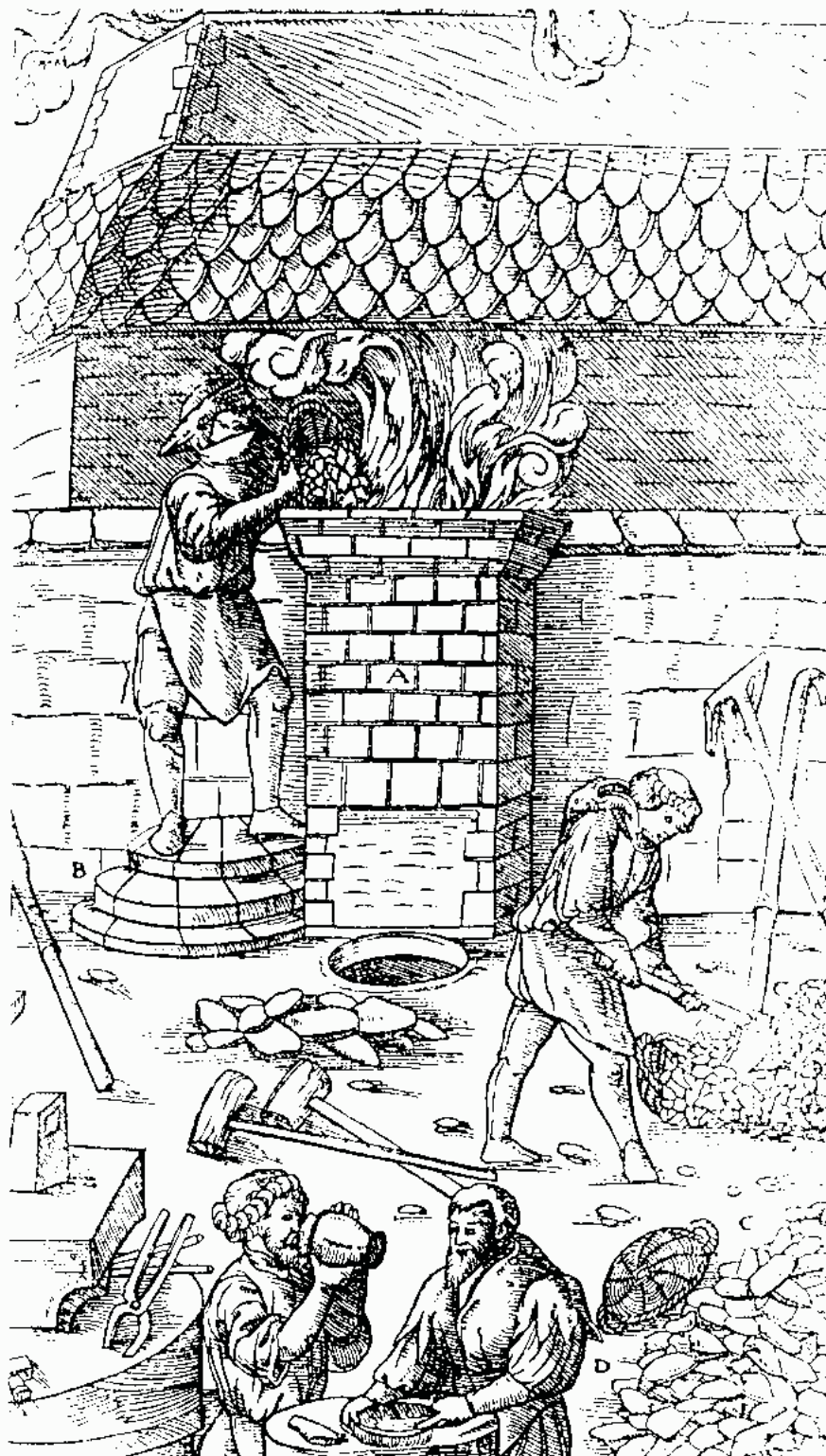
FIGURE 2.2 – Gravure d'un four à masse extraite de l'ouvrage De Re Metallica (Agricola, 1556).
