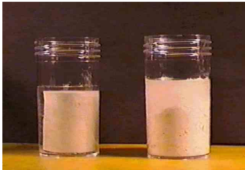
Photo 4-6 : Echantillons de craie de Lixhe immergés dans de l'eau : à gauche, échantillon intact - à droite échantillon ayant subi une déformation de 20%. Etat au bout de 10 minutes.
