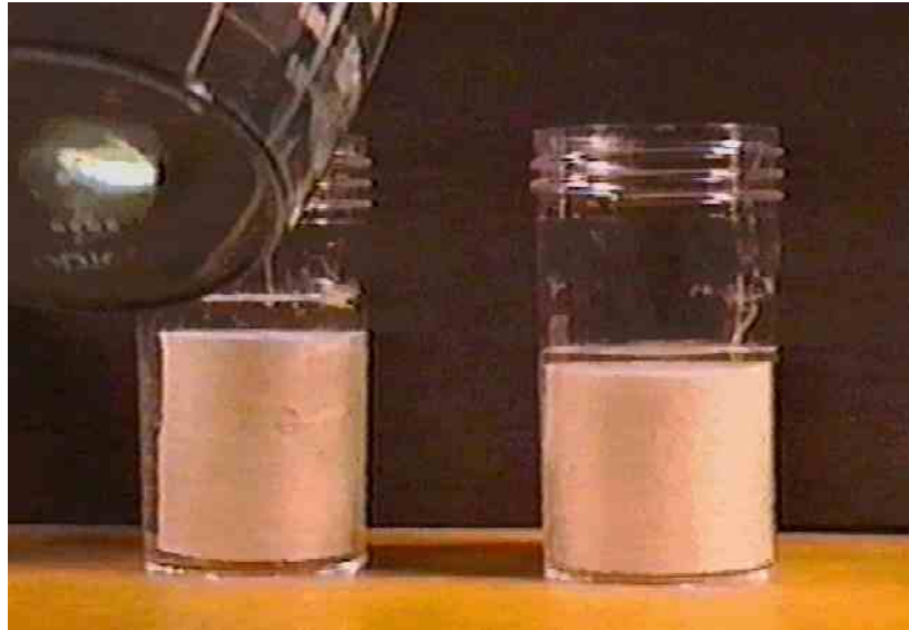
Photo 4-5 : Echantillons de craie de Lixhe immergés dans de l'eau : à gauche, échantillon intact - à droite échantillon ayant subi une déformation de 20%. Etat initial
