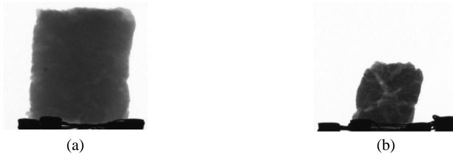
Figure 2-39 : Tomographie à rayons X d'un échantillon de boue de station d'épuration (a) mouillé et (b) sec (Léonard, 2003)
