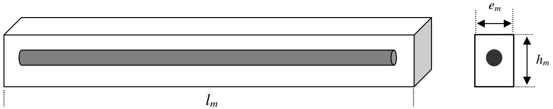
Figure 4.27 : Electrode horizontale entourée d'une couche de matière de faible résistivité.
