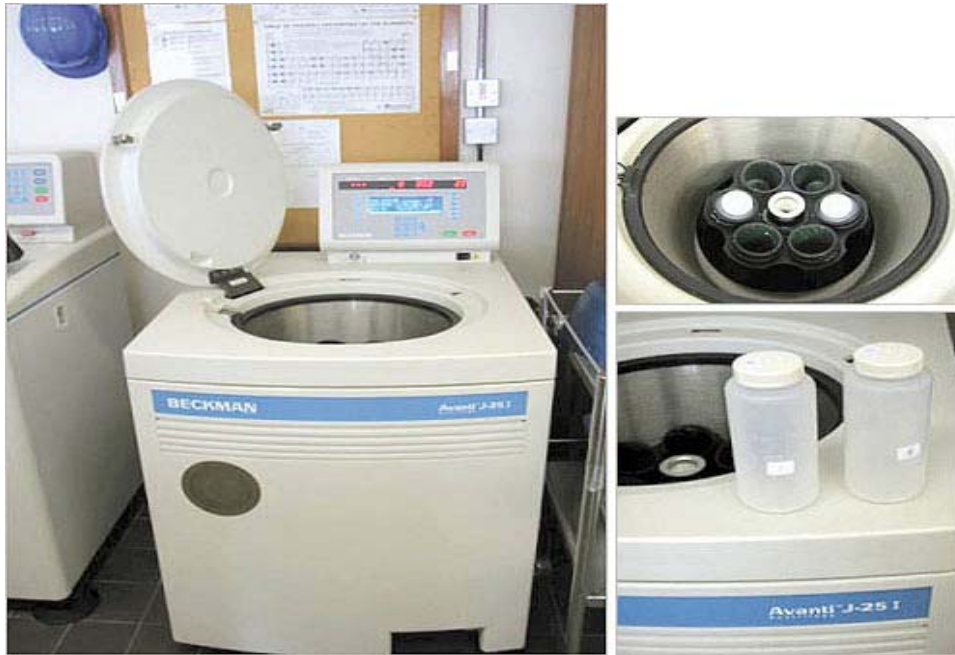
Centrifugeuse Beckman Avanti J25 servant à la concentration des cellules après la fermentation dans les réacteurs
