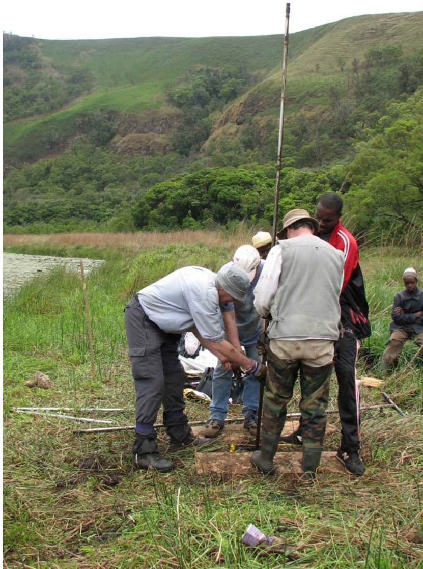
Figure 9a. Carottage en bordure du lac Bambili à l'aide du carottier manuel russe.
