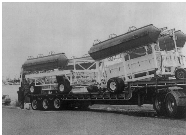
Figure 3 : Une unité d'ECOSUB2 (à gauche) et la navette permettant de transporter les blocs de matte sur le site receveur (à droite).
