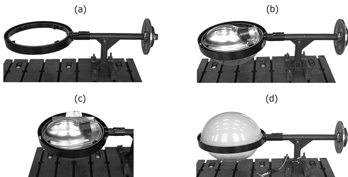
FIG. 5.15 – Dispositif expérimental pour l'analyse modale au marteau d'impact du système « support/luminaire Super Saturne 400 W » assemblé pièce par pièce : (a) Support + couronne ; (b) + Bloc optique ; (c) + Tiroir ; (d) + Capot
