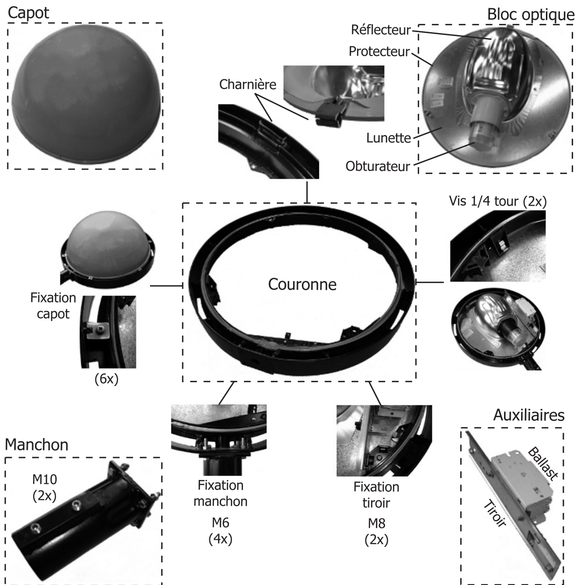
FIG. 5.11 – Eclaté du luminaire Super Saturne 400 W
