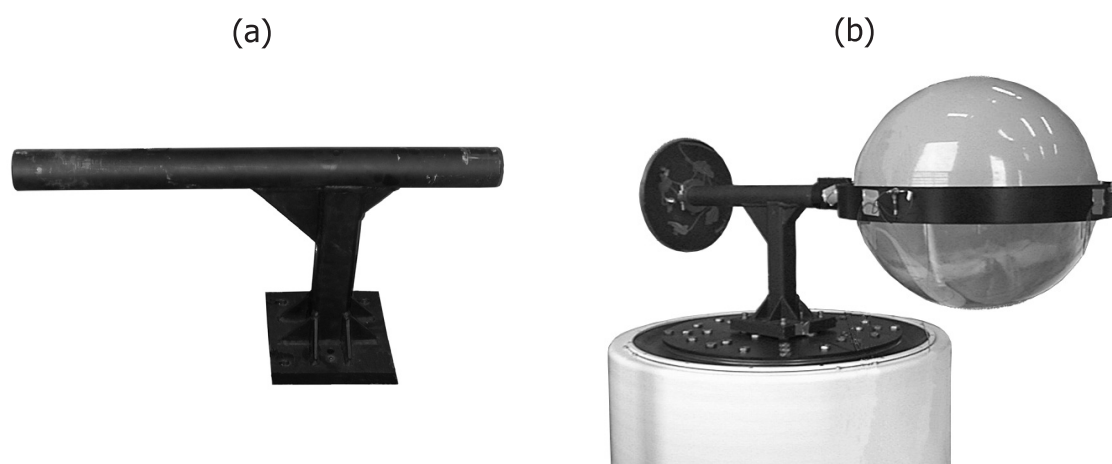
FIG. 5.12 – Essai du luminaire Super Saturne 400 W sur table vibrante : (a) Support de test ; (b) Intégration du luminaire sur son support et position du contre-poids
