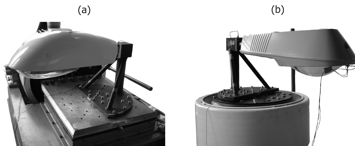
FIG. 5.57 – Application de la spécification aléatoire, enveloppe des effets du vent, au cas de deux luminaires dits « étalons » : (a) Luminaire Saphir 2 ; (b) Luminaire Hélios
