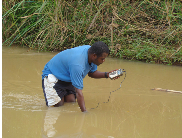
Fig.2.2. Mesure de conductivité dans la rivière Luidi (le 03/02/2008)
