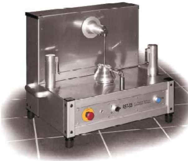
Figure IV-27: Equipement utilisé pour la mesure de la force de cisaillement nécessaire pour mettre la poudre en mouvement
