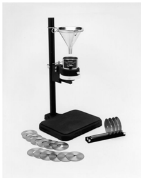
Figure IV-25: Représentation du Flodex ® utilisé pour la détermination du diamètre minimum de l'orifice d'écoulement
