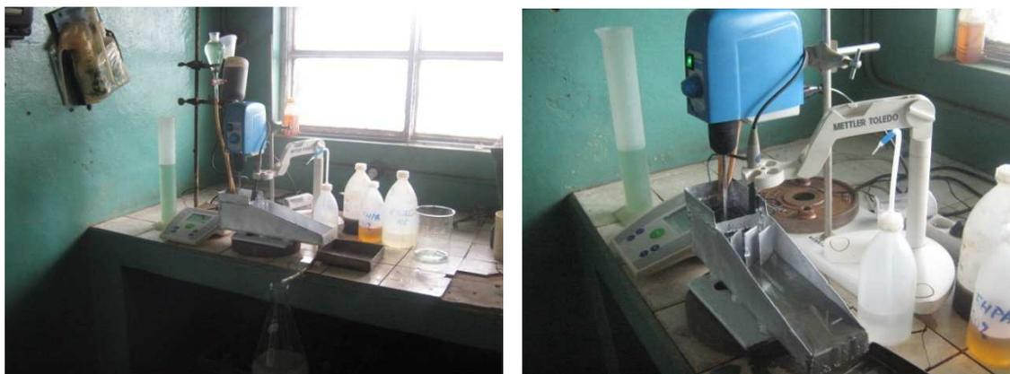
**Figure 18 - Extraction par solvant semi-continue dans une unité mixer-settler de laboratoire**
