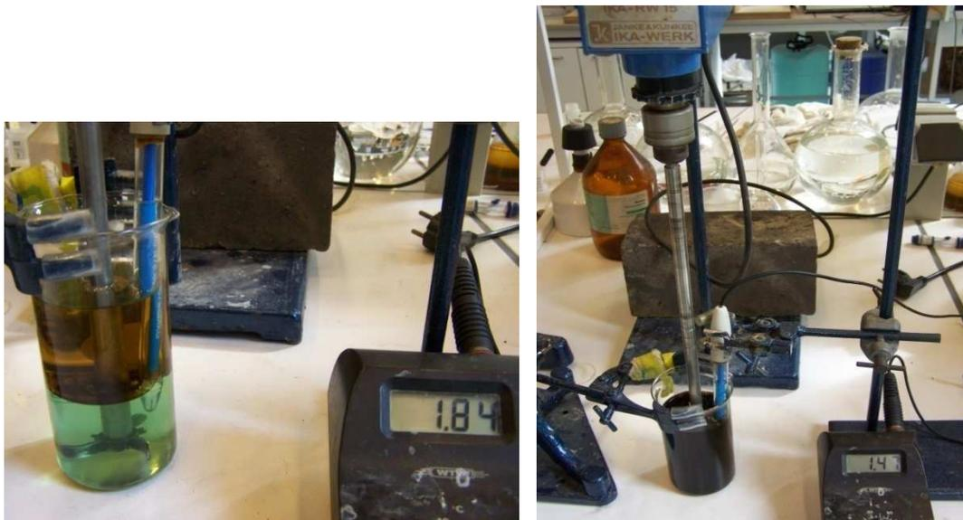
**Figure 17 - Extraction par solvant en discontinu dans un bécher**
