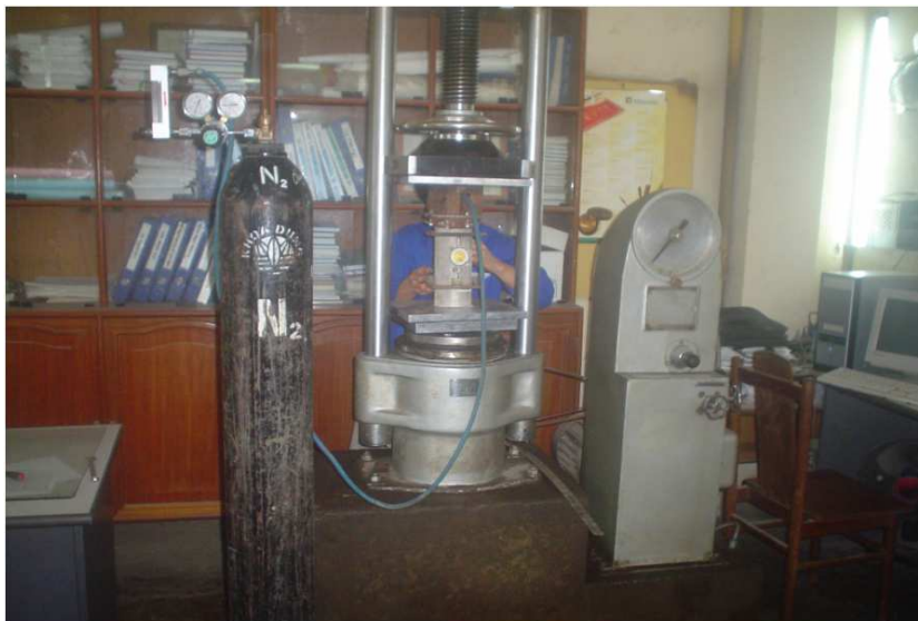
Figure 4.6 – Vue générale des équipements pour la mesure de la perméabilité au gaz
