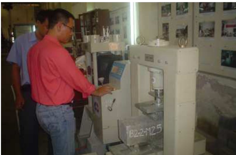
Figure 2.11 – Essai de flexion des poutres entières sur quatre points
