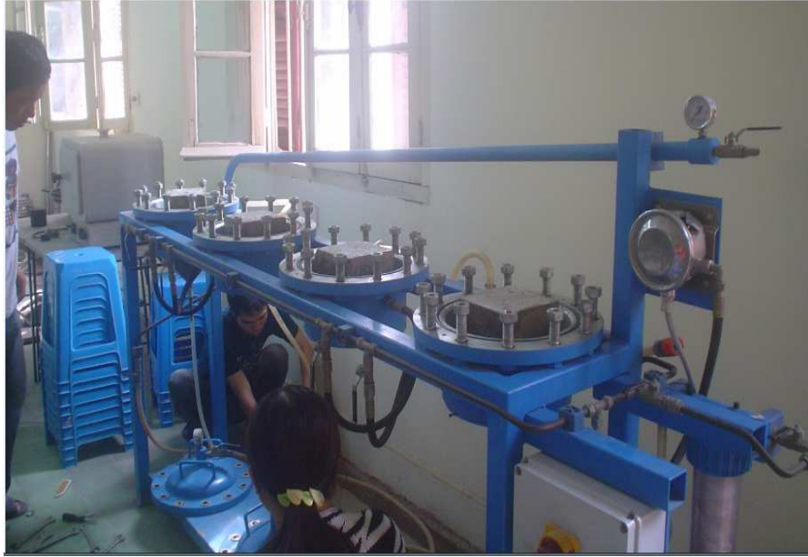
Figure 4.23 – Vue générale des équipements pour la mesure de la perméabilité à l'eau
