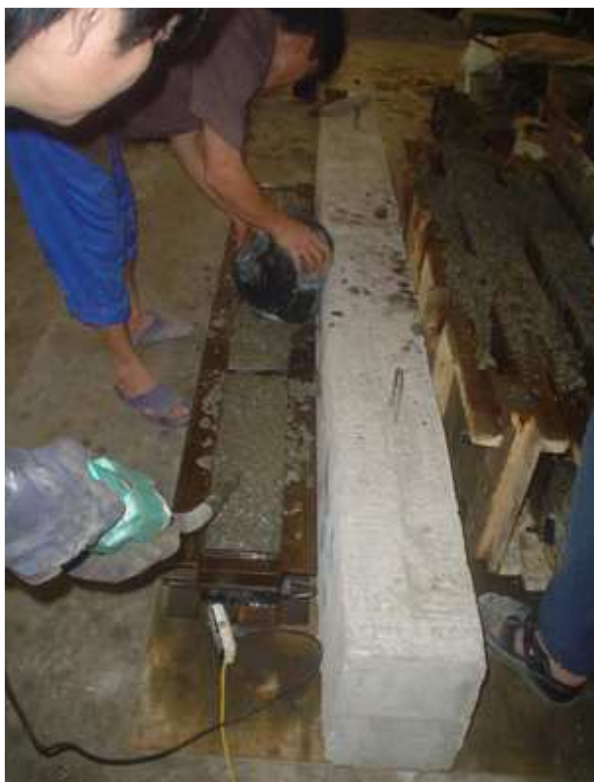
Figure 2.8 – Fabrication des éprouvettes de poutre entière
