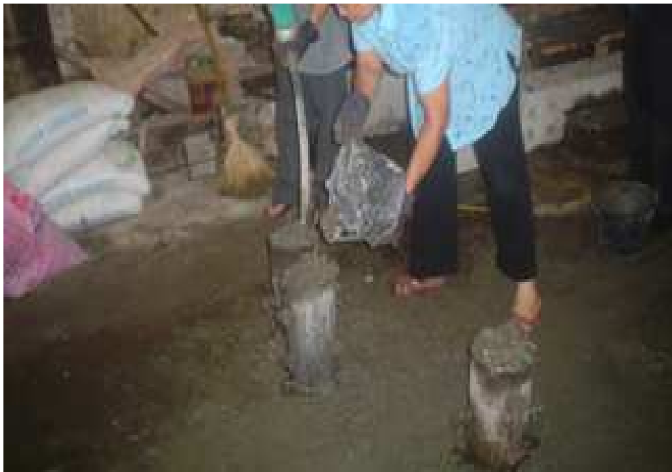
Figure 2.7 – Fabrication des éprouvettes cylindriques
