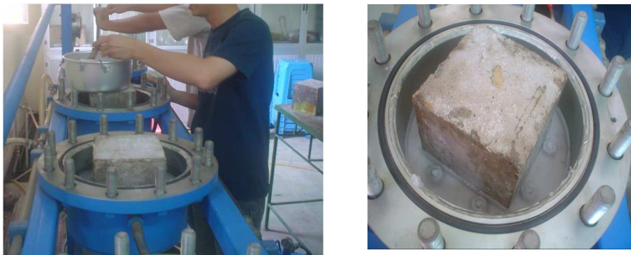
Figure 4.24 – Versement de la paraffine liquide dans la cellule de mesure
