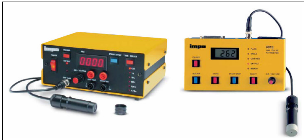
Figure IV.26. Vue du Compteur Geiger Müller RM3
