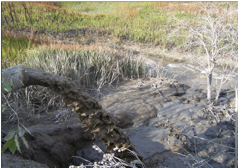
Figure VI.16 Vue de la persistance des bulles sur l'effluent liquide d'un concentrateur du Katanga
