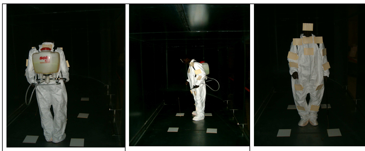
Figure 5.7. : Tunnel de mesures pour essais sur 2 rangées de pavés aux positions dos, latérale et face à la direction du vent.
