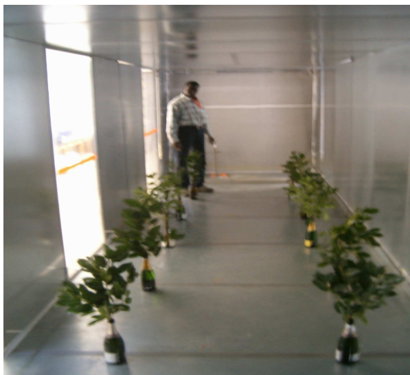
Figure 5.10. : Tunnel de mesure avec présence d'une végétation artificielle.
