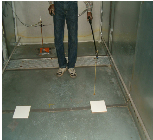
Figure 5.8. : Corde de réglage de la hauteur de pulvérisation dans le tunnel.
