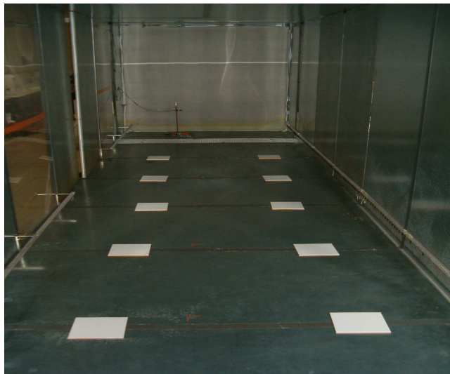
Figure 5.9. : Tunnel de mesures pour essais sur 2 rangées de pavés.
