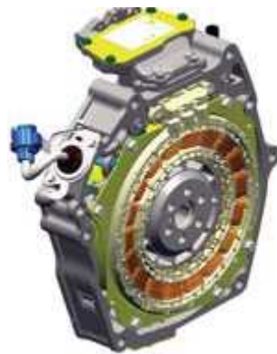
Figure 2.5: Machine électrique de la Honda Insight
