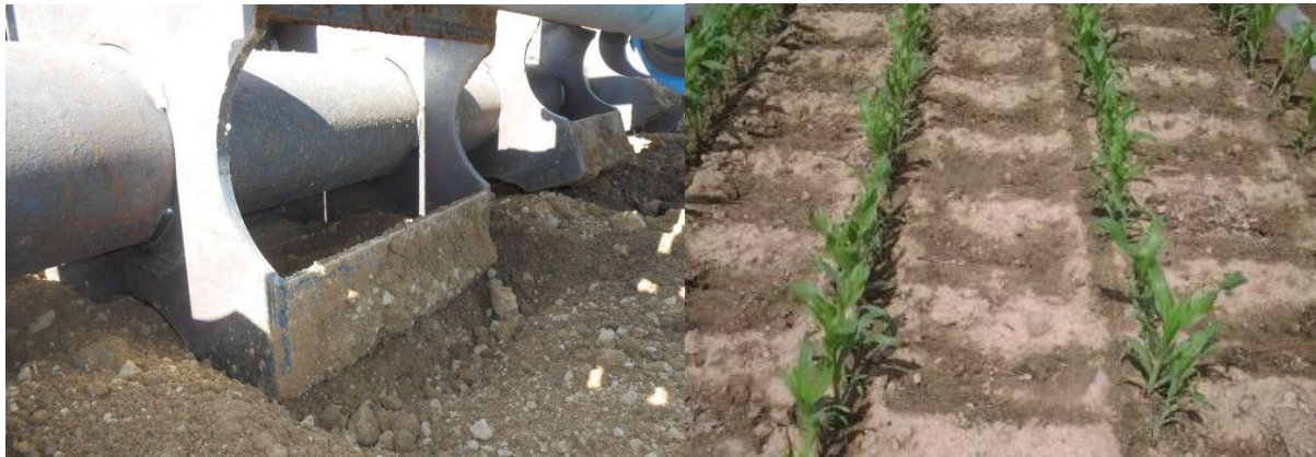
Rouleau antiérosif en maïs. Des microcavités sont creusées dans l'inter-rang lors du semis.
