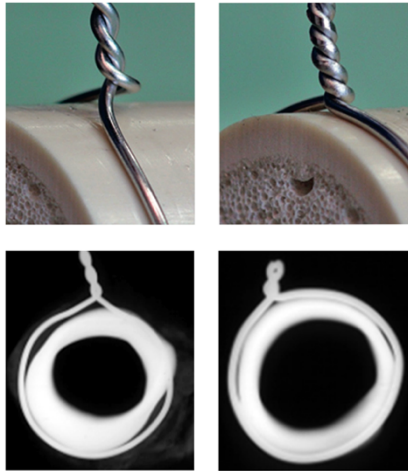
Figure 24 : Différents types de torons lors de l'utilisation d'un câble classique avec leurs répercussions sur la tension transmise au cerclage (27)
