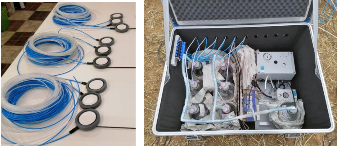
Figure 3. Plaques de prélèvement et boîte isotherme contenant les bouteilles de recueillement et la pompe à vide.
