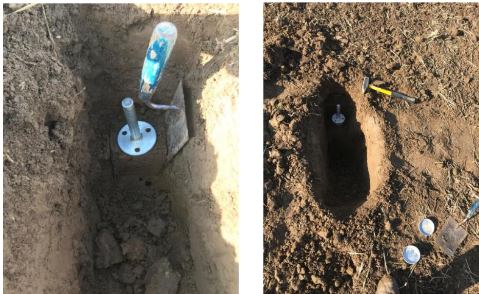
Figure 24. Méthode de prélèvement des échantillons en structure conservée à 30 cm de profondeur.
