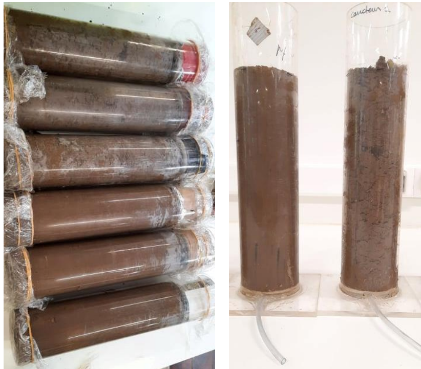
Figure 37. Colonnes prélevées au carotteur en haut sur la photo de gauche et à droite sur la photo de droite en comparaison aux colonnes prélevées à la main.
