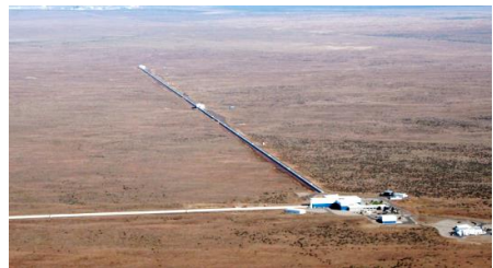
à gauche : duo d'interféromètres LIGO – USA deux bras orthogonaux de L = 4 km haut : Livingston (Louisiane) – bas : Hanford (Washington)
