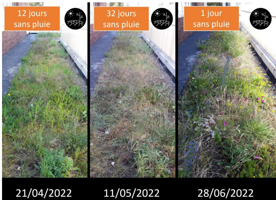
Figure 7-3 : Evolution d'une zone ombragée de la toiture in situ après un épisode de sécheresse printanier
