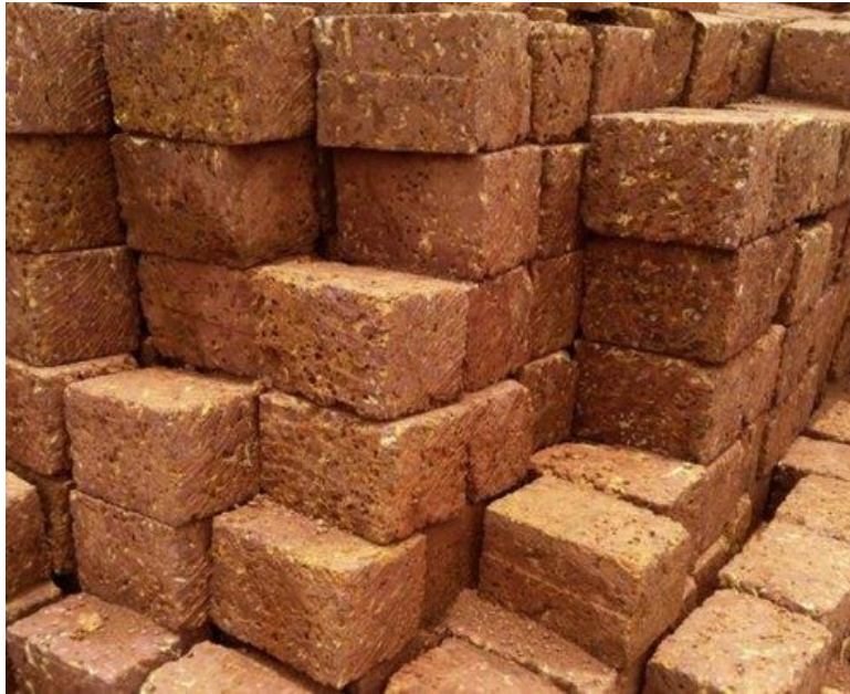
Image 34. Blocs de latérite taillée
