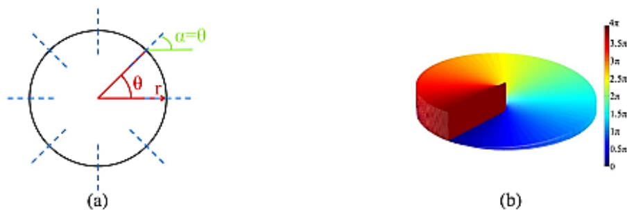
Figure 13 - Résumé : Représentation d'un vortex retardateur de phase et de la phase du faisceau transmis
