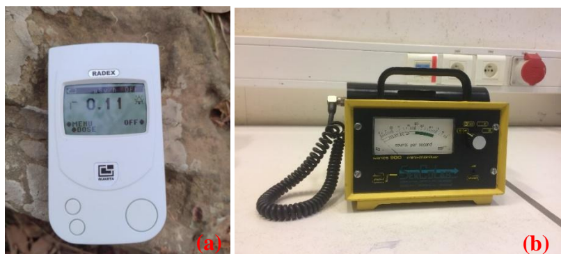
Figure III. 1. Photographie d'un dosimètre Radex de terrain (a) et d'un compteur Geiger-Müller de laboratoire (GeMMe) (b).
