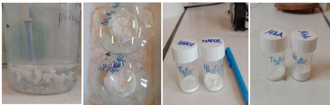
Figure G.1. De gauche à droite : germination d'un précipité de Ta, oxydes hydratés de Ta et de Nb, oxydes purs après calcination (prêts pour les analyses).
