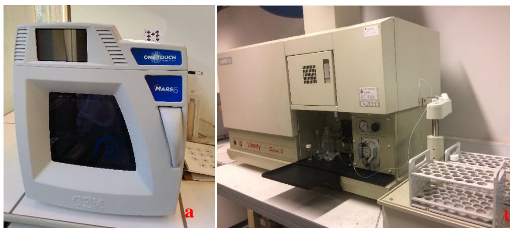
Figure III. 5. Digesteur à micro-ondes (a), et le spectromètre ICP-AES Varian Liberty 100 (b) utilisés respectivement pour la minéralisation et l'analyse des solutions d'attaque.
