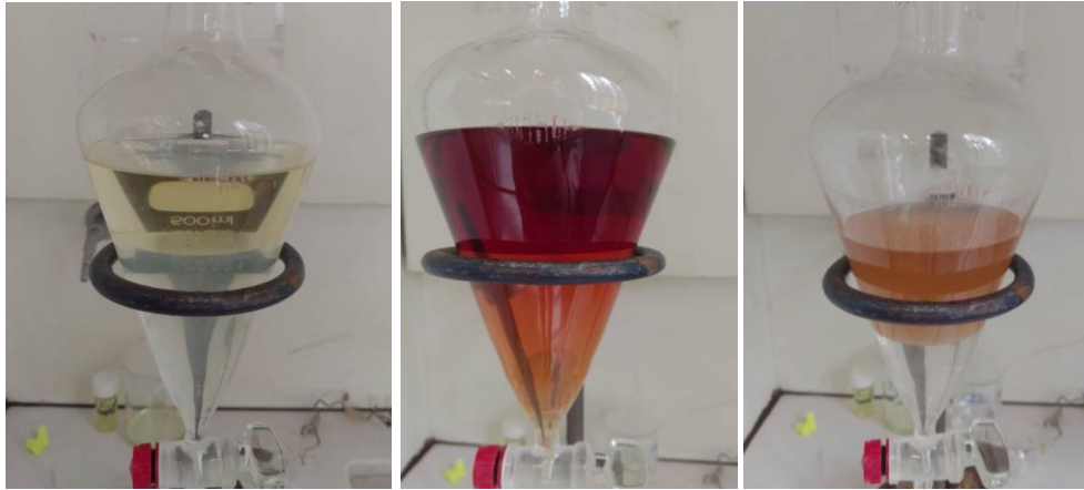
Figure F.1. Apparence des phases organiques et aqueuses à l'équilibre suivant l'intervalle d'acidité : (a) à acidité <7M pour le MIBK, (b) à acidité 12M pour le MIBK, le volume de la phase aqueuse a augmenté, montrant que le MIBK se dissout dans le phase aqueuse, (c) à acidité 12M pour l'OCL, le volume de la phase aqueuse est plus ou moins inchangé.
