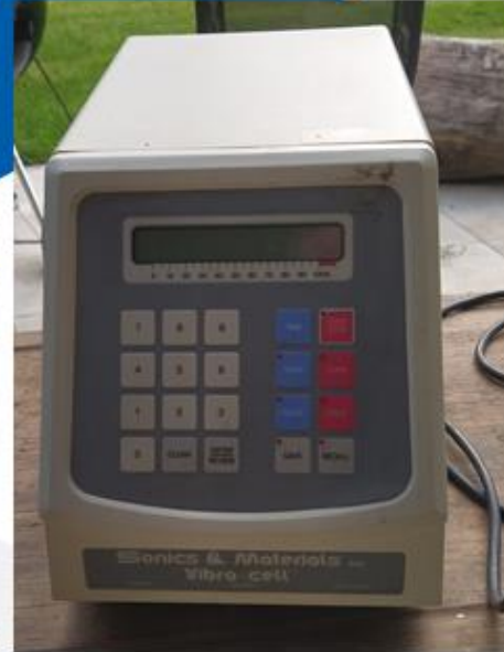
Figure 28 : Deuxième appareil à ultrasons (600 W et 30 kHz).
