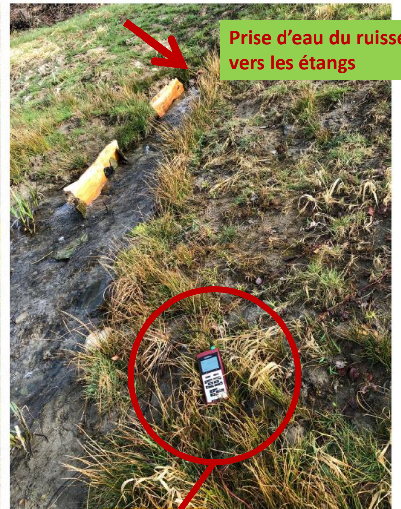
Figure 9 : Conductimètre placé au milieu de l'écoulement.
