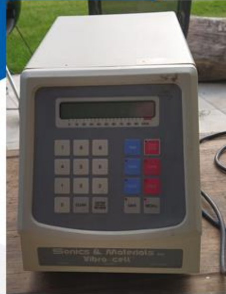
Figure 28 : Deuxième appareil à ultrasons (600 W et 30 kHz).
