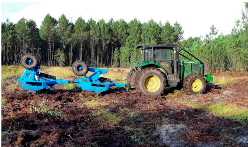
Figure 3. Double rouleau landais traîné par un tracteur agricole. Le rouleau landais est un rouleau d'environ 2 mètres de large, équipé de 6 à 7 lames métalliques, qui est utilisé dans de nombreuses opérations sylvicoles. Il existe différents types de rouleaux landais, allant de 750 à 5000 kg.
