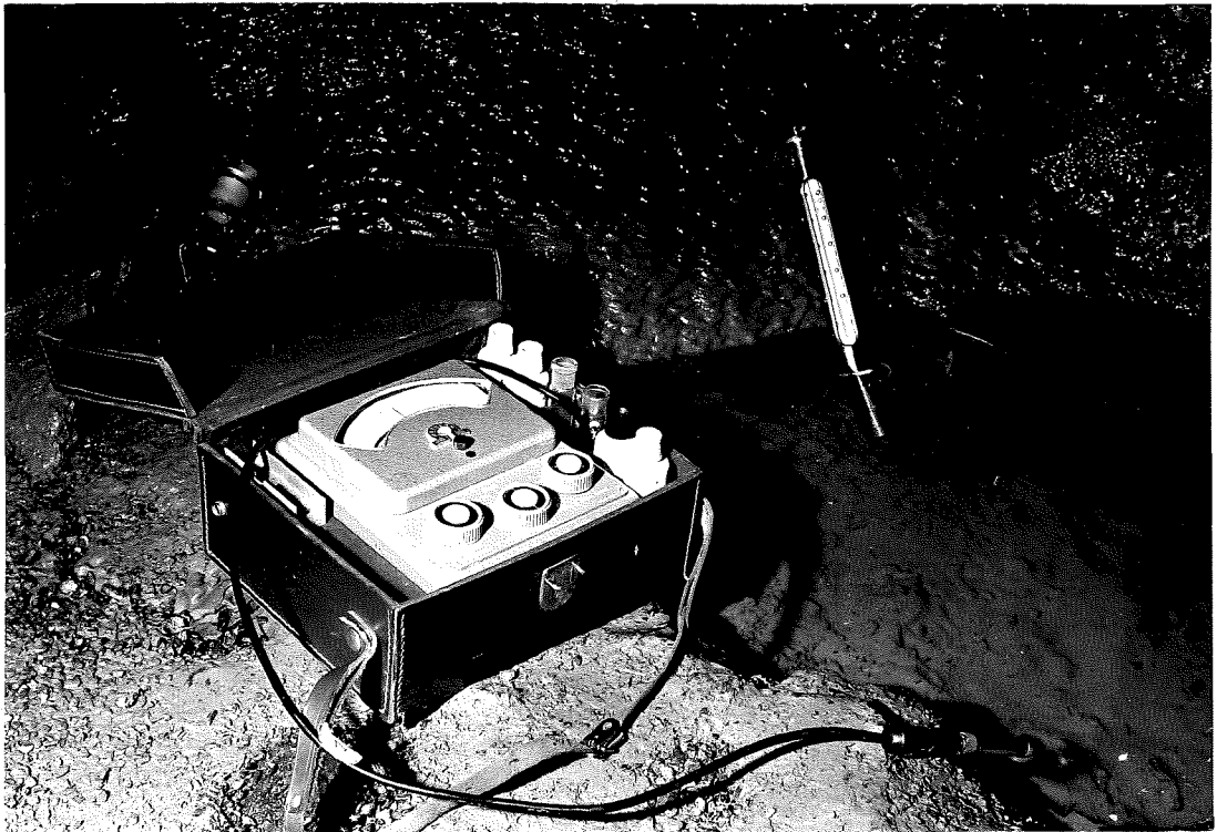
PHOTO 1. Prélèvement d'eau dans la Grotte de Comblain-au-Pont. pHmètre avec son électrode combinée, et thermomètre hydrologique.
