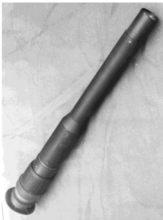
Фигура 3. Оптична система – прицел 15 К
