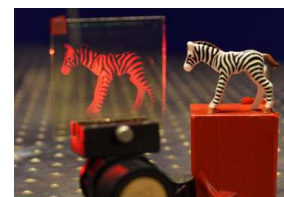
Hologramme de transmission effectué à l'ENSAT - Lanion Yoann Atlas : HeNe (633 nm) - plaque Ultimate Holography
