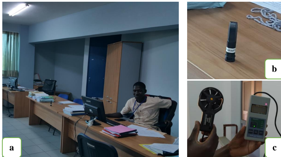
Figure 4.6: (a) Vue d'ensemble d'un bureau collectif ; (b) Capteur de température et d'humidité ; (c) Anémomètre
