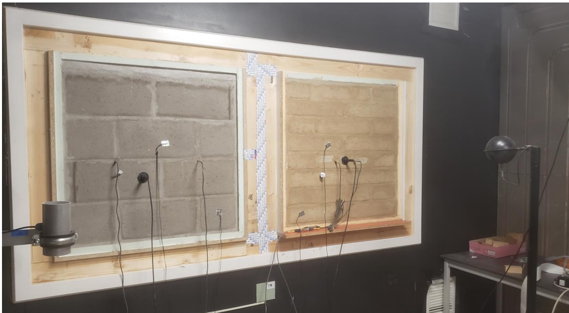
Figure 6.4: Instrumentation des parois en BTC_{8\_Bel} - 1 et en blocs de béton creux
