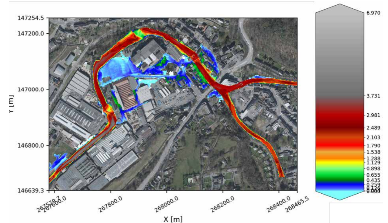
Figure 12 – Hauteurs d'eau [m] pour une répartition égale du Q100 entre la Helle et la Vesdre.
