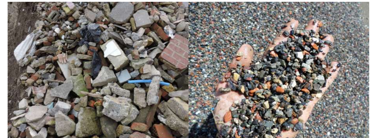
(a) (b) Figure 1 – Déchets de démolition avant (a) et après (b) traitement.
