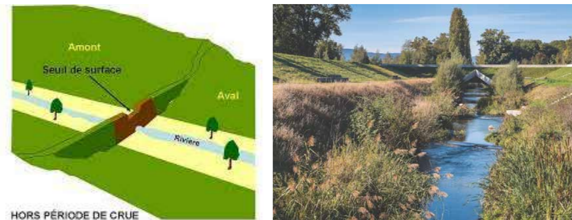
Figure 20 – Gauche : Représentation schématique d'un barrage avec pertuis déterminant une zone d'immersion temporaire en amont ; Droite : Exemple de pont pertuis sur l'Aire (Suisse).
