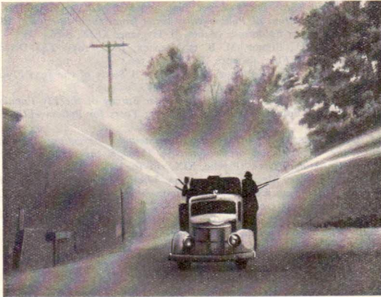
Un aspect de la lutte contre les Mouches domestiques au cours d'une épidémie de poliomyélite aux U.S.A. Un camion automobile pourvu de 4 lances pulvérise une émulsion de DDT (1 à 2 %) dans la ville de Savannah (d'après J. L. MELNICK, R. WARD, D. R. LINDSAY et F. E. LYMAN, 1947).
