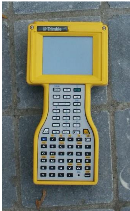
Figure 13.4.3. Unité de contrôle, d'affichage et d'enregistrement d'un récepteur de la marque Trimble.
