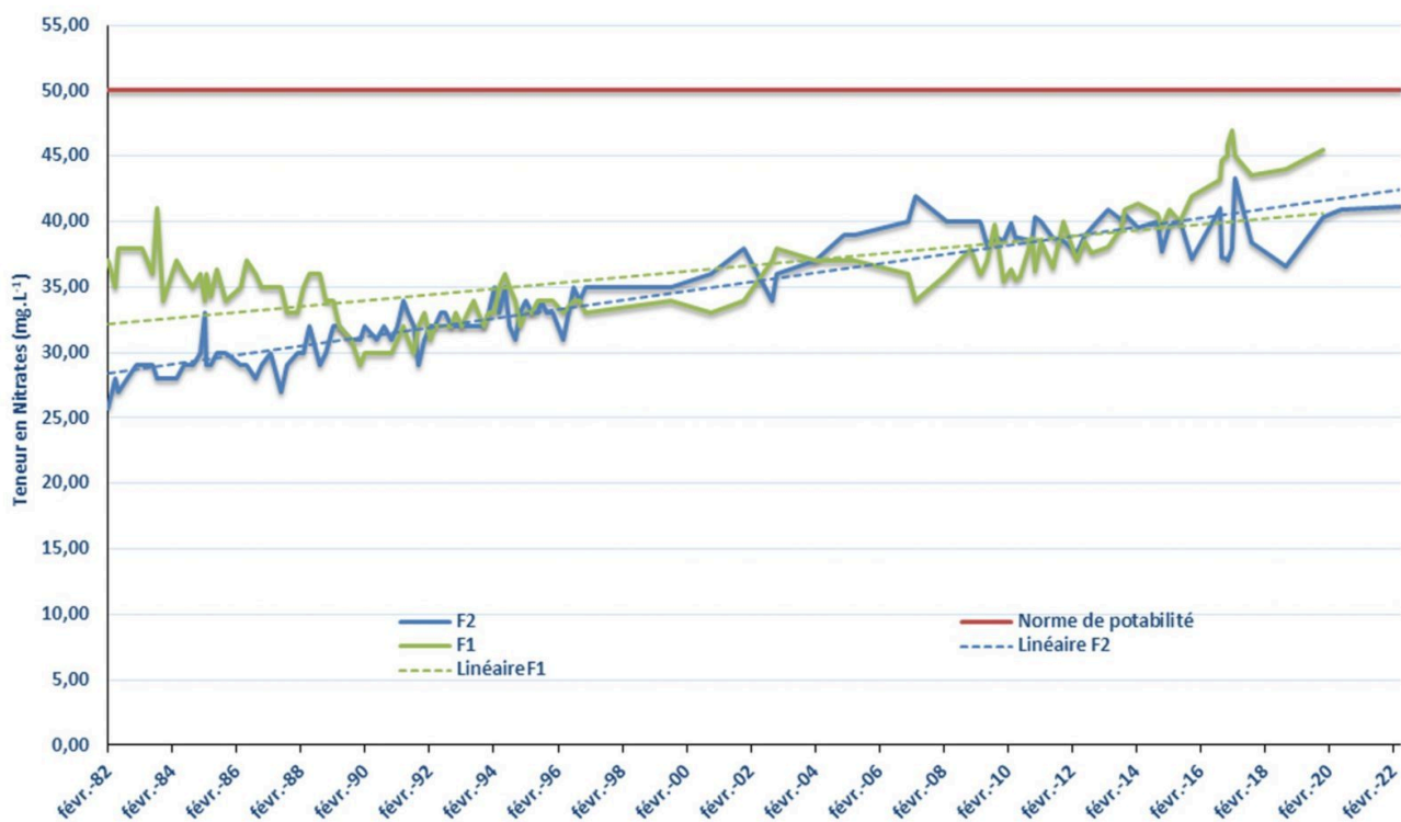
Figure 1. Évolution de la concentration en nitrate aux captages de Baugy (F1 & F2).
