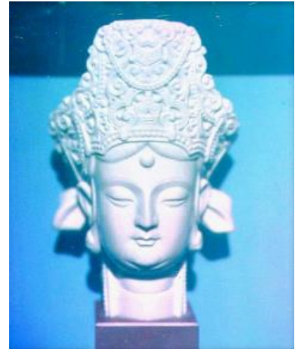
Hologramme couleur haute résolution réalisé par Hans Bjelkhagen (UK) c Ultra-Realistic Imaging ® Taille des grains des émulsions : 20 - 25 nm On notera la qualité du blanc particulièrement difficile à reproduire
