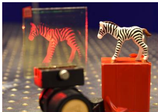
Hologramme de transmission - Yoann Atlas, ENSSAT – Lanion (F) : lu avec un LASER HeNe (632,8 nm) * plaque Ultimate Holography U0870 5
