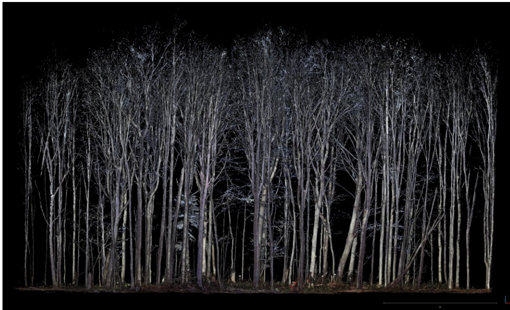
Figure 15. Exemple d'une acquisition TLS multi-scan (5 scans) dans une placette de feuillus (sans feuilles) de 11.28 m de rayon (+ 10 m de buffer) située à St-Quentin (NB).
