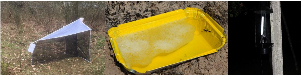
Figure 5 : Illustration de quelques pièges fréquemment utilisés : piège Malaise en activité avec au point le plus haut le dispositif de récolte, piège coloré et piège lumineux (Photos RBINS, J. Fagot, RBINS).
