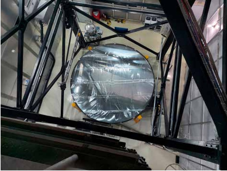
◀ Vue du miroir de l'ILMT recouvert d'une pellicule de mylar.
