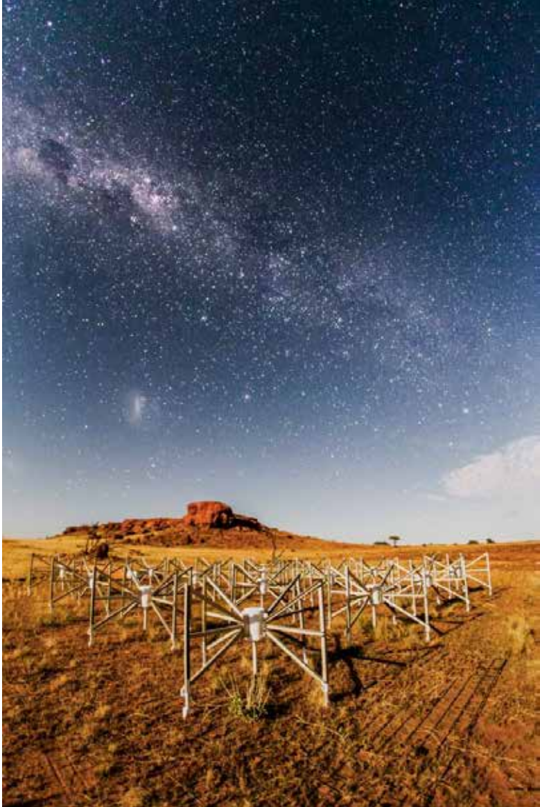
L'élément 107, ou « l'aberration » comme on l'appelle, est l'un des 256 du MWA, à 1,5 km du cœur du réseau. Le MWA est un instrument précurseur du SKA. (Pete Wheeler, ICRAR)
