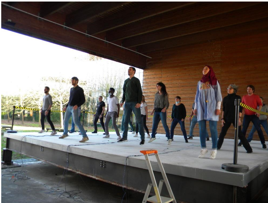
Figure 5: Illustration d'essais rythmiques avec 16 personnes sur le plancher de laboratoire
