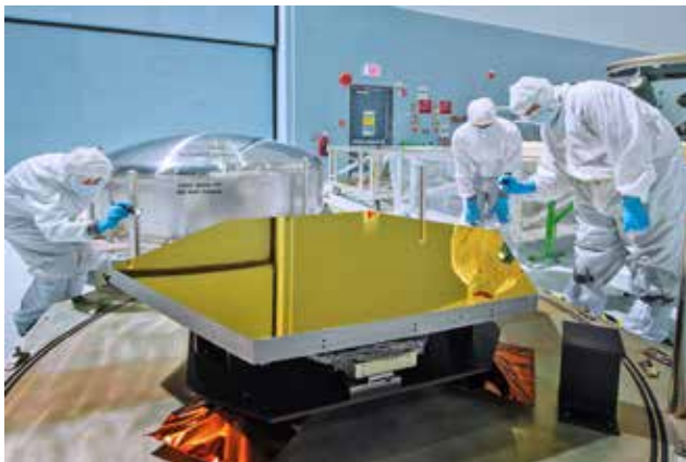
Inspection, en 2012, de l'un des segments du miroir primaire dans une chambre propre du centre Goddard de la NASA. (NASA Goddard/Chris Gunn)
