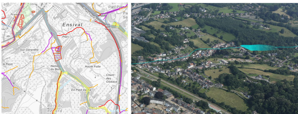
Figure 7. f.3 – Potentiel d’élargissement de création d’une zone de stockage sur le site du Préry à Enival. Extrait de la cartographie de l’aléa d’inondation (SPW-TLPE – 2022 sur fond IGN) avec le périmètre ISA. Vue aérienne du site illustrant le potentiel d’élargissement. Photo : SPI © 2021, graphisme LEMA 2022.
