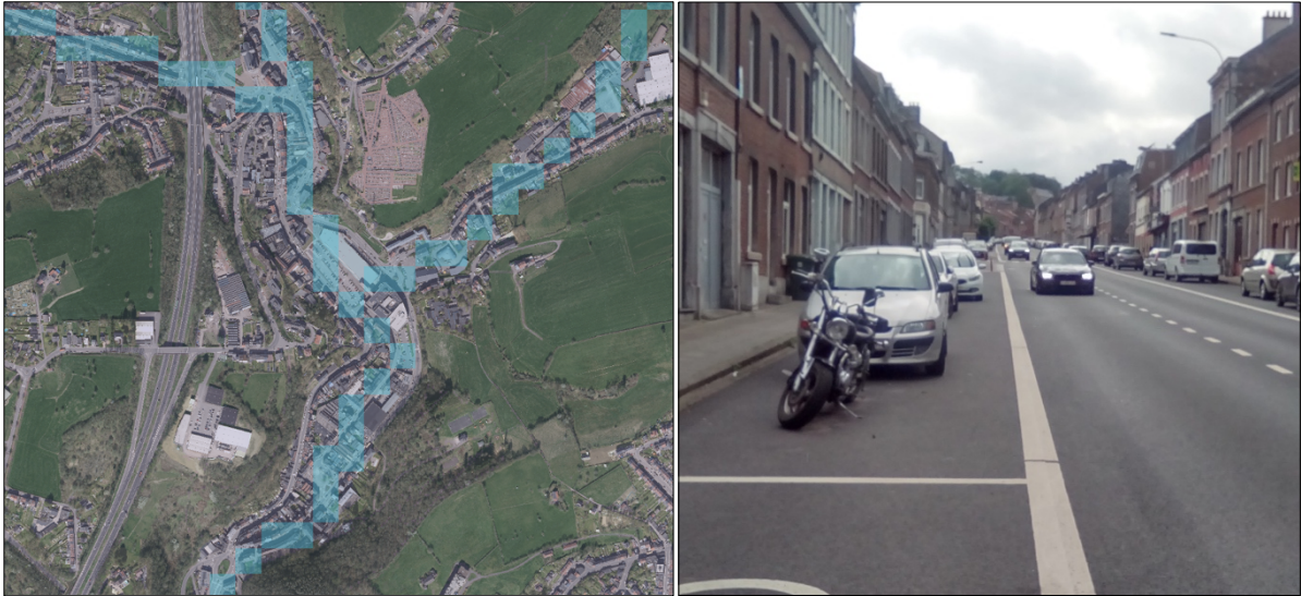
Figure 7. g.5 – A gauche, « exutoire » du sous bassin versant incluant la commune de Dison. Les points de concentration des ruissellements correspondent à des surfaces imperméabilisées (routes, habitation et parking). A droite, photo de la rue principale où se concentrent les ruissellements.
