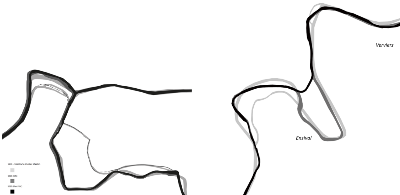
Schéma 12 – Transformation progressive du lit mineur. Réduction de l’ampleur du lit mineur avec le recouvrement d’une grande partie du réseau de biefs : cas de Pepinster à gauche et d’Ensival à droite.
