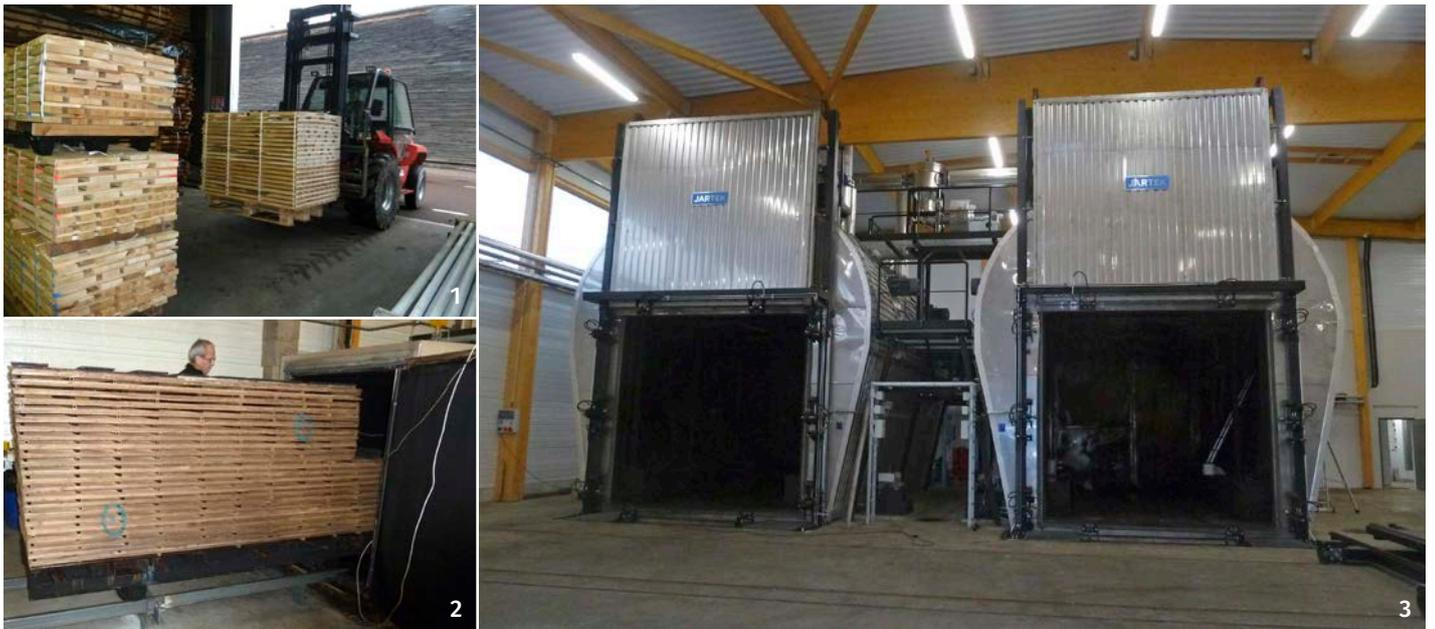
(1) Planches de bouleau avant traitement dans le four Jartek® à l'entreprise Bois durable de Bourgogne. (2 et 3) Traitement des planches de bouleau dans le four Jartek® (1 m<sup>3</sup>) et les deux grands autres fours Jartek® de 20 m<sup>3</sup> de l'entreprise Bois durable de Bourgogne.
