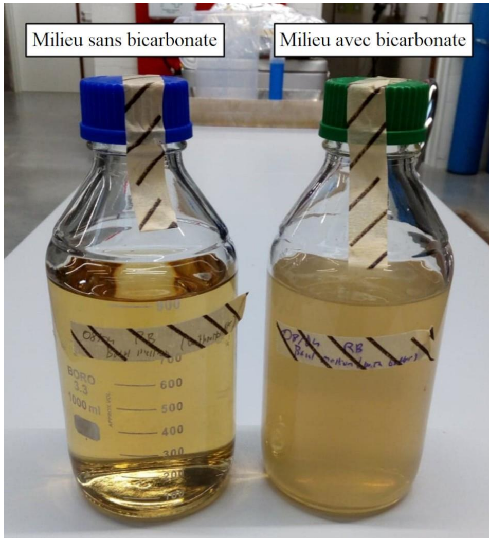
Figure 45 : Présence d'insolubles dans le milieu basal de culture de T. xylanilyticus lorsque du bicarbonate de potassium (5 g/L) était ajouté dans le milieu afin de réaliser un système tampon avec du dioxyde de carbone. La photo est prise à la sortie de la stérilisation des milieux par autoclavage.
