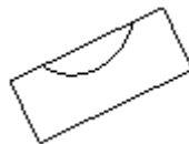
Figure 7.3.2. Représentation de la nivelle à l'écran de la station totale lors d'une mauvaise mise en station approximative.
