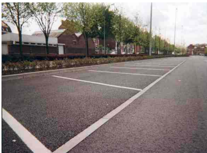
Figure 13 - Parking avec revêtement poreux à Douai
