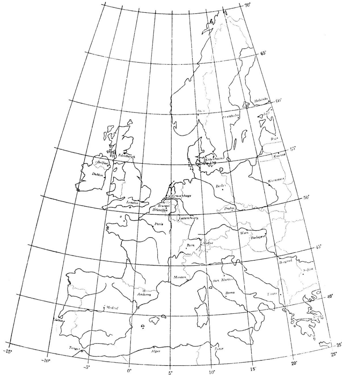
Figure 3.4.5. Carte d'Europe occidentale dans la projection conique équivalente de BONNE.
