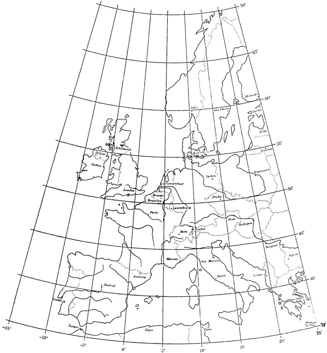
Figure 3.4.10. Carte de l'Europe occidentale dans la projection de LAMBERT sur cône sécant. Les parallèles fondamentaux sont à 42^{\circ} et à 57^{\circ}30' .
