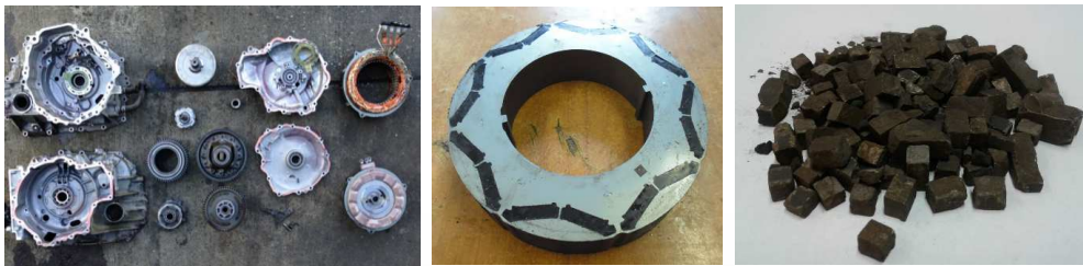
Démantèlement manuel et récupération des aimants NdFeB après démagnétisation thermique
