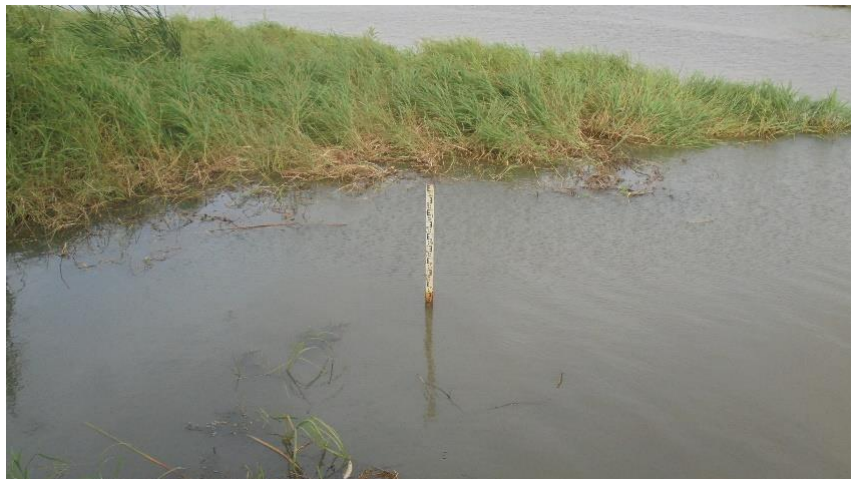
Photo 28 : Jauge limnimétrique sur le plan d'eau du lac (CSS)
