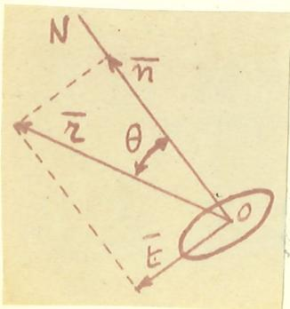
avec la normale  $ON$ , mais fait avec celle-ci un angle de glissement  $\theta$ . La projection de  $\bar{r}$  sur  $ON$  est la composante normale (ou tension normale)  $\bar{n}$ . La projection normale de  $r$  sur la facette est la composante tangentielle (ou tension tangentielle)  $\bar{t}$ . Si  $\theta = 0$ , la tension est purement normale, elle est purement tangentielle si  $\theta = \frac{\pi}{2}$ . Suivant leur sens, les tensions normales sont des tractions ou des compressions
