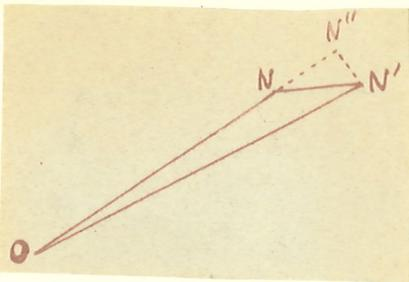
Considérons un segment dirigé ON avant déformation. Après déformation il est devenu ON'. Projétons ON' en ON'' sur ON. On appelle dilatation unitaire en O suivant ON.
