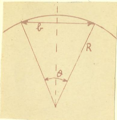
Si la tranche présente une certaine courbure, de rayon  $R$ , et que la base de mesure est  $b$ , on mesure suivant la corde et non suivant l'arc. on mesure
