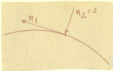
La dilatation  $\epsilon_1$  étant mesurée ainsi qu'il a été dit,  $n_1$  s'en déduit facilement et exactement, indépendamment du coefficient de Poisson, difficile à mesurer, par la seule connaissance de  $E$  généralement bien connu et facile à
