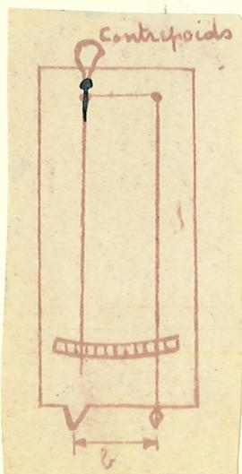
Prototype Appareil Mesnager  $b = 50$  mm, pas d'axe ni de couteaux, articulations à lames. Amplification 2000.
